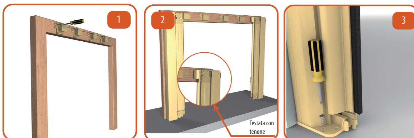
Fissare i supporti reggi guida nella parte superiore del telaio.
