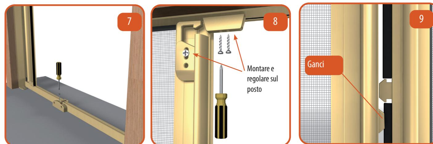
Posizionare a terra e fissare con le viti il reggi guide inferiori.
